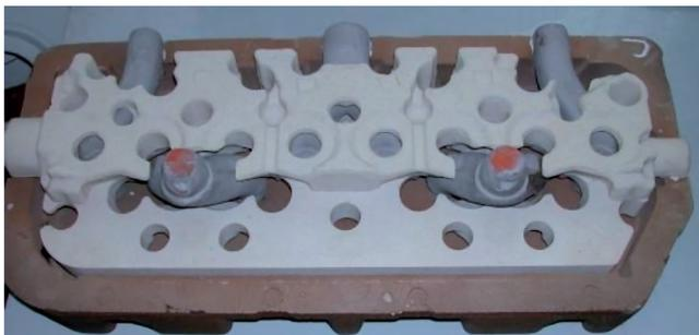
Рис. 3. Комплект стержней отливки «головка блока цилиндров» 240-1003015
