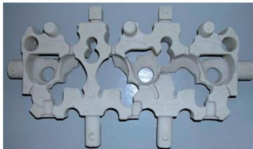
Рис. 4. Цельный стержень «рубашка водяного охлаждения» отливки «головка блока цилиндров» 260-1003015
