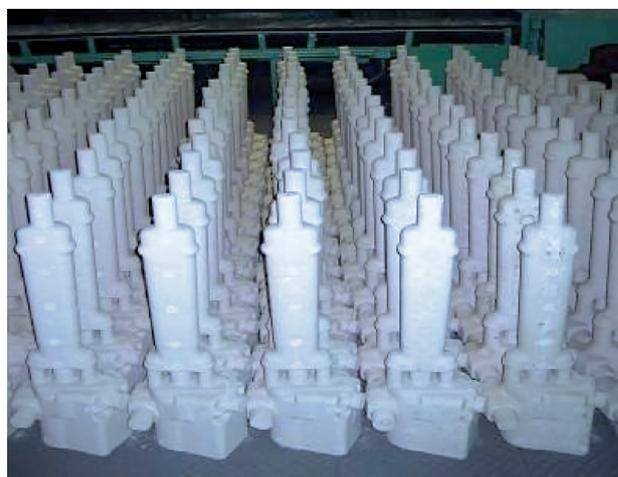
Рис. 7. Стержни отливки «гидроусилитель руля», изготовленные по Амин-процессу
