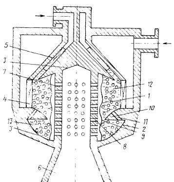
Изобретение относится к энергетике, в частности к редукционно-охлаждающим устройствам, предназначенным для редуцирования и охлаждения перегретого пара в пускосборных устройствах тепловых и атомных электростанций, работающих на переменных режимах.
