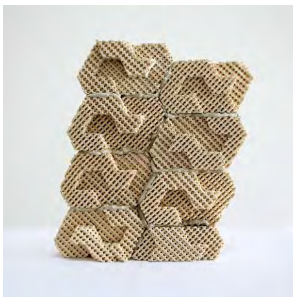
Рисунок 2 – Пример соединения блоков
