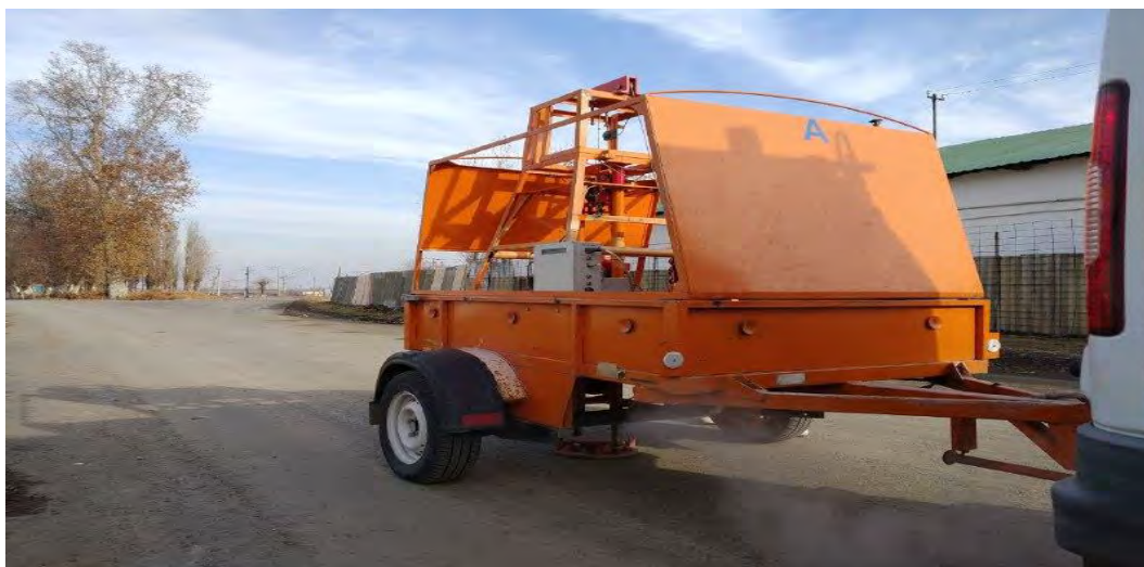
Рисунок 1 – Установка ДИНА-3 с приборами динамического нагружения
