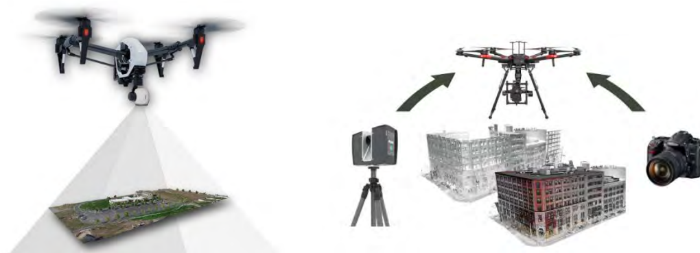
Рисунок 2 – Принцип работы квадрокоптера и результат 3D сканирования
