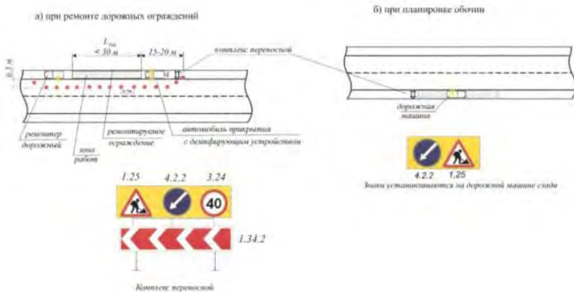
Рисунок 4 – Организация движения при проведении работ по содержанию автомобильной дороги
