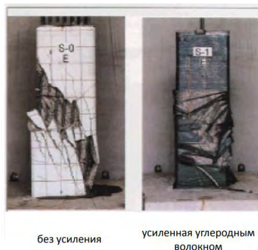
Рисунок 3 – Сравнение сейсмостойкости колонн, армированных и неармированных углеродным волокном
