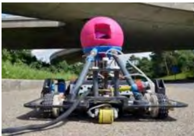
Рисунок 1 – C2D2, робот для определения коррозии, разработанный в Швейцарии
