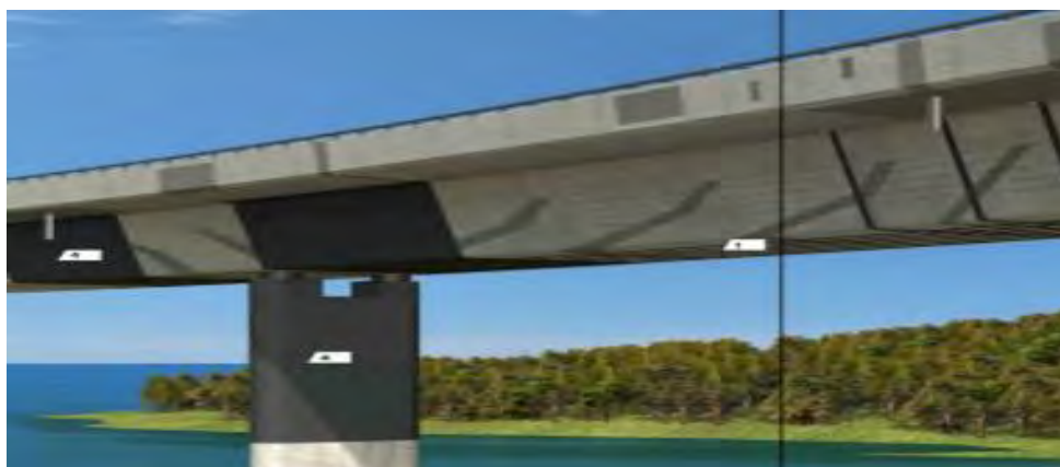
Рисунок 1 – Пролёт моста усиленный углеволокном.
