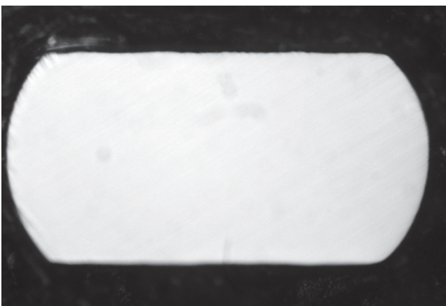
Рис. 5. Вид плющенной проволоки после обработки сдвливающими напряжениями со стороны закругленных концов
