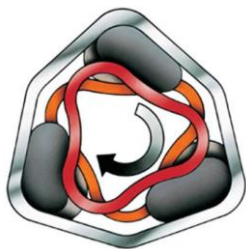
Рисунок 2 – Деформации жгутов при работе
