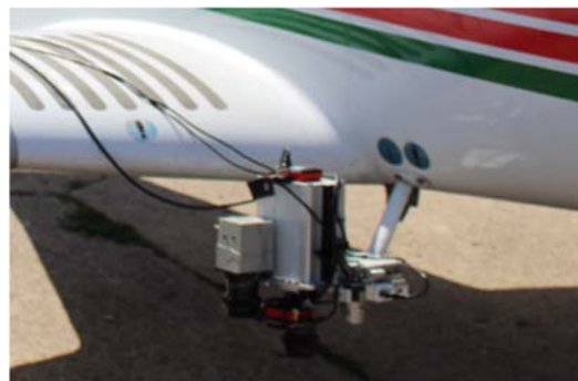
Рисунок 2 – Прибор МКСС-1, подготовленный для проведения авиасъемки с борта самолета Diamond DA40NG
