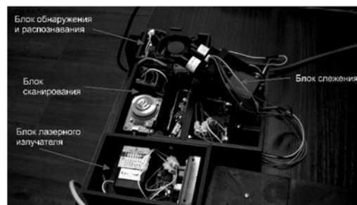
Рисунок 2 – Общий вид разработанного макета лазерного локатора
