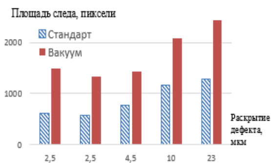
Рисунок 2 – Сравнительные диаграммы по пропитке дефектов пенетрантами при использовании вакуумной интенсификации
