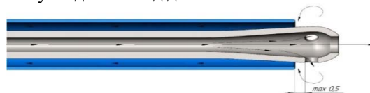
Рисунок 3 – Схема движения потоков жидкости через систему, включающую инструмент-волновод и катетер
