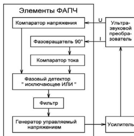
Рисунок 2 – Структурная схема элементов двухчастотной системы ФАПЧ УЗГ
