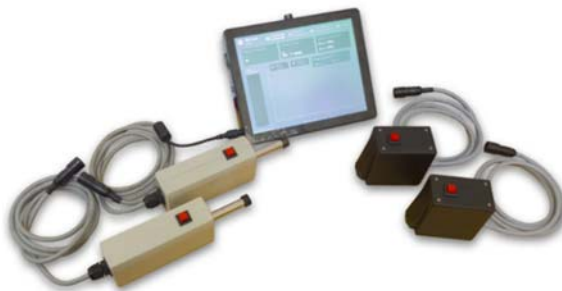
Рисунок 1 – ИИК НТ-800 с датчиками для контроля покрытий в труднодоступных местах и на плоских поверхностях
