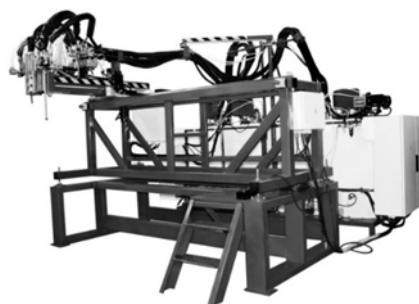
Рисунок 1 – Многофункциональный комплекс по подготовке и автоматической заливке наполненных и ненаполненных мультикомпонентных гибридно-композитных смесей
