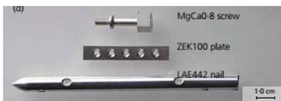
Рисунок 5 – Ортопедические имплантаты для остеосинтеза из биodeградируемых магниевых сплавов [15]
