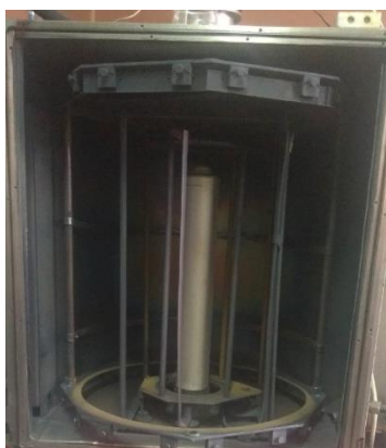
Рис. 1. Вакуумная камера с протяженным катодом
