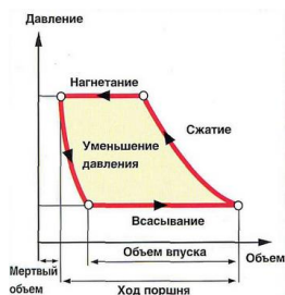
Рис. 1. Индикаторная диаграмма поршневого компрессора
