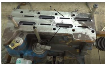
Рис. 1. Клапанная решетка: 1 – впускной канал; 2 – выпускной канал
