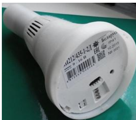
Рисунок 2 – Общий вид опытного образца дымового пожарного извещателя
