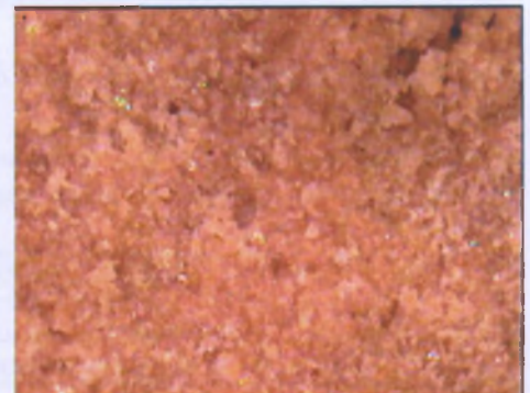
Рисунок 3 – Поверхность доломита после ее обработки сульфатом натрия
