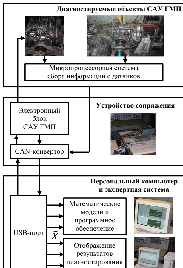
Рисунок 1 – Технология диагностирования ГТ посредством экспертной интеллектуальной системы
