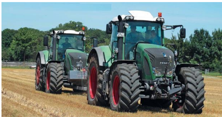
Рисунок 1 – Трактор фирмы Fendt на полевых испытаниях по регулированию давления воздуха в шинах
