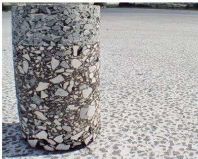
Рис. 1. Асфальтоцементобетон (вид готового покрытия)
