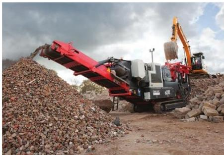
Рис. 6. Мобильный дробильный комплекс
