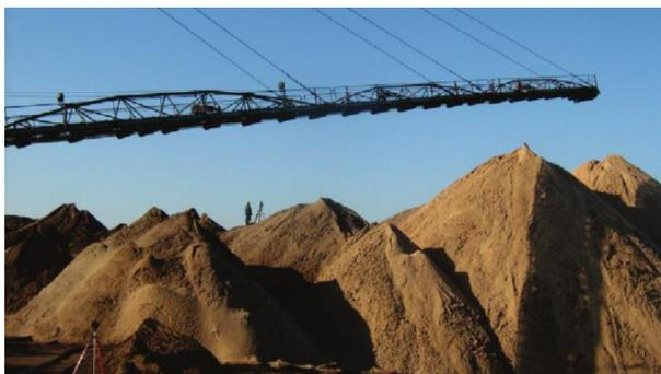
Рис. 1. Солеотвалы. Использование лазерного сканера Leica ScanStation C10 для создания цифровой модели рельефа
