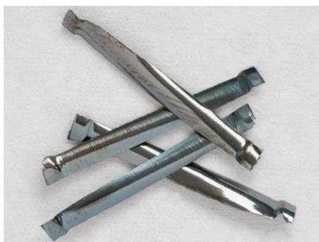
Рис. 2. Стальная фрезерованная фибра из сляба
