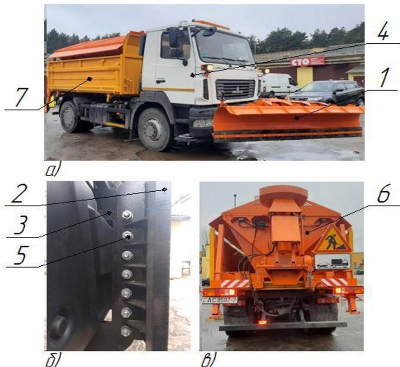
Рис. 2. Многофункциональная машина на базе автомобиля МАЗ- 5550С5:
