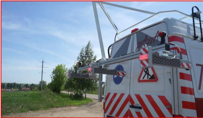
Рис. 4. Система фиксации дефектов дорожной одежды
