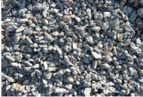
Рис. 1. Цементгранулят, используемый при испытаниях
