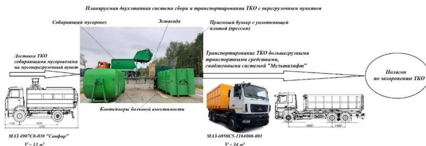
Рис. 2. Двухэтапная система сбора и транспортирования ТКО
