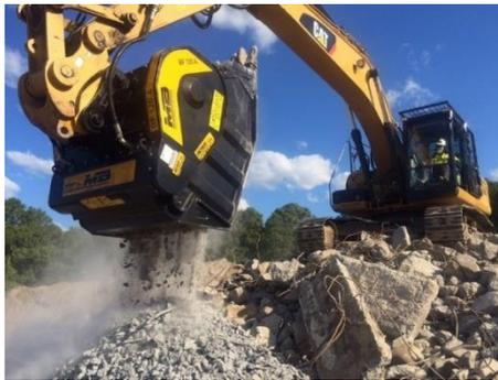
Рис. 5. Экскаватор с навесным оборудование (ковш дробилка)
