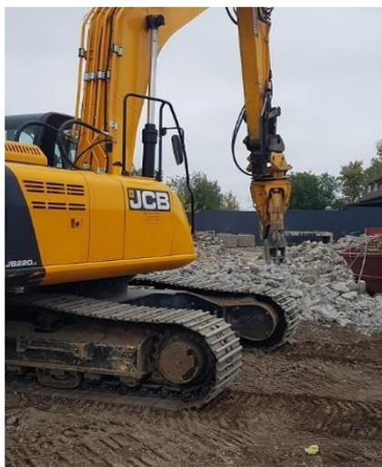
Рис. 2. Экскаватор с навесным оборудованием (бетонолом)
