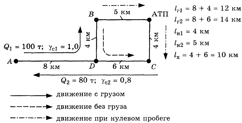
Рис.3.8. Схема кольцевого маршрута перевозки грузов
