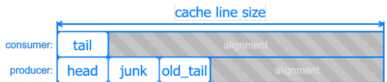
Рисунок 2 Выравнивание указателей очереди в памяти с целью разделения потоков производителя и потребителя по разным кэш-линиям
