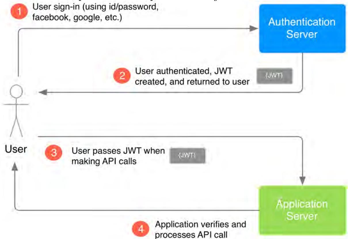
Рисунок 4 – схема аутентификации при помощи JWT
