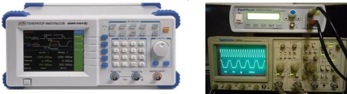
Рисунок 5. Генераторы прямоугольных и треугольных колебаний
