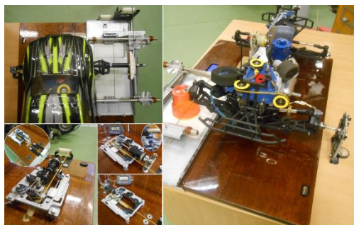
Рисунок 1 – Экспериментальное оборудование для определения параметров системы рулевого управления и подвесок физической модели автомобиля
