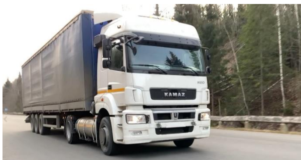
Рисунок 1 – Автомобиль КАМАЗ, оборудованный двигателем, конвертированным для работы на природном газе, во время испытаний на автополигоне «НАМИ»
