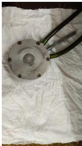
Рисунок 2 – Доработанная проставка для охлаждения
