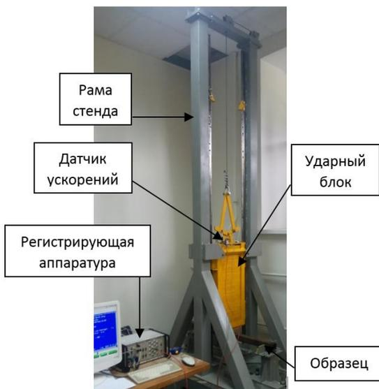
Рисунок 1 – Общий вид установки
