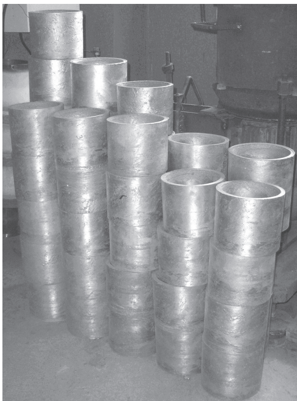
Рис. 2. Заготовки подшипников скольжения из антифрикционного силумина
