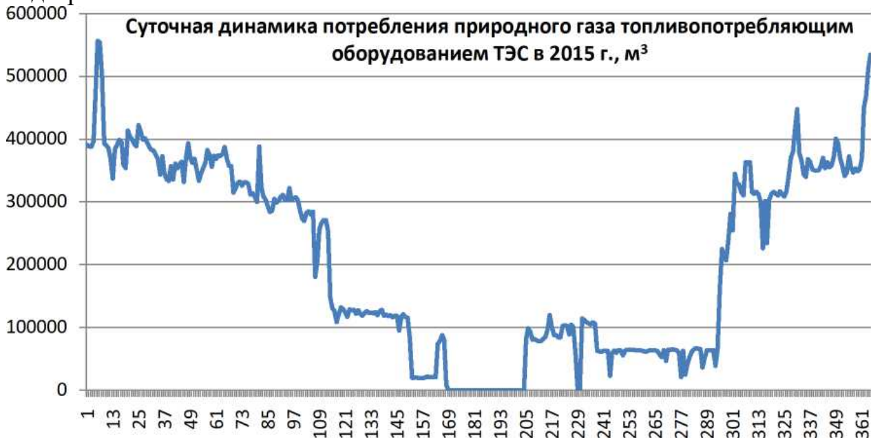
Рисунок 2 – Суточная динамика потребления природного газа топливопотребляющим оборудованием ТЭС в 2019г.
