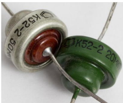
а б Рисунок 2 – Конденсатор: а – реальное изделие; б – 3D-модель
