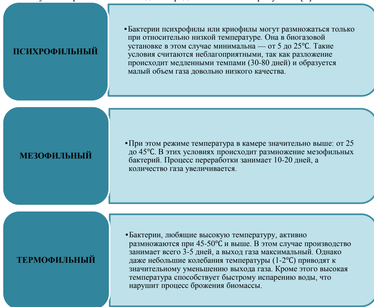
Рисунок 2 – Методы получения биогаза
