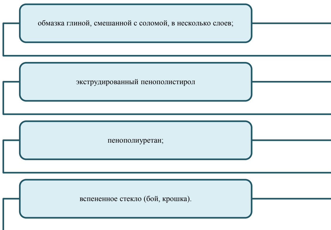
Рисунок 3 – Варианты утепления стенок биореактора
