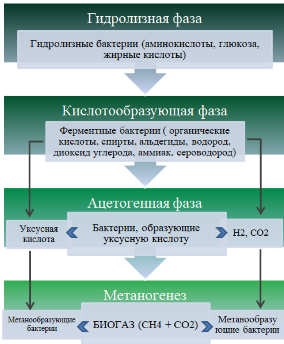
Рисунок 4 – Фазы образования биогаза
