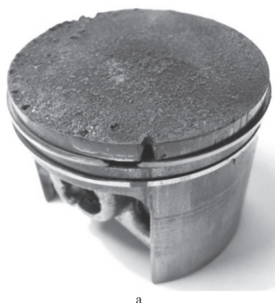
Рис. 1. Прогар поршня: а – разрушение периферийной зоны; б – разрушение центральной зоны
