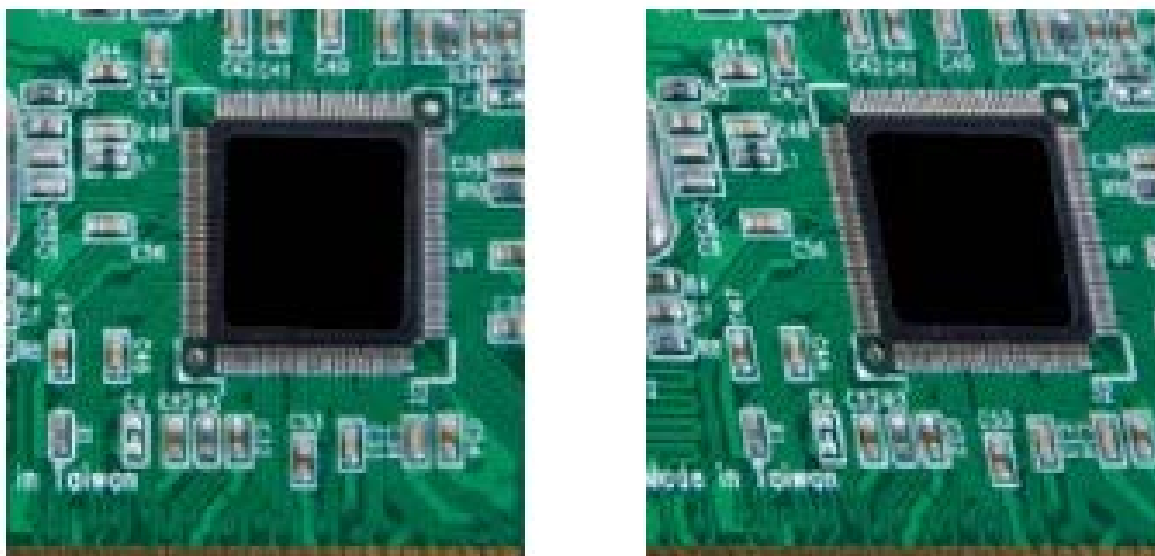
Рисунок 7 – Сравнение размытия движения в глобальных и рольставнях: чип датчика на медленно движущемся конвейере с глобальной заслонкой (слева) и рольставнями (справа)
