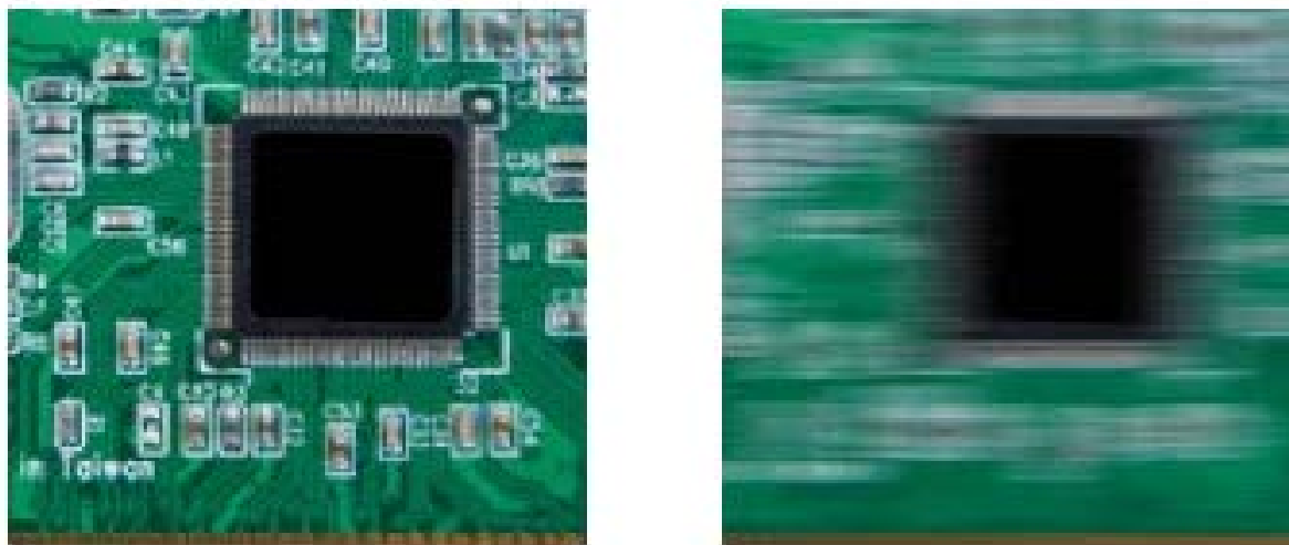
Рисунок 6 – Сравнение размытия в движении: чип датчика на быстро движущемся конвейере с глобальным затвором (слева) и непрерывным глобальным затвором (справа)
