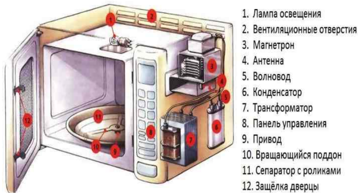
Рисунок 4 – Устройство печи СВЧ
