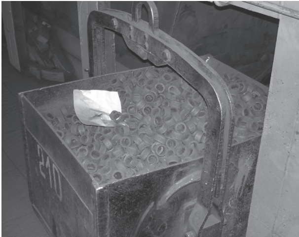
Рис. 4. Партия отливок «ниппель1¼», содержащая повышенное содержание отливок со структурой СЧ
