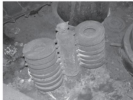
Рис. 5. Отливка «Фланец Ду65» с литниковой системой
