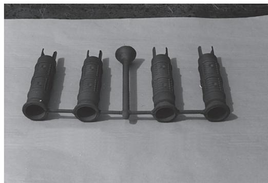
Рис. 8. Отливка «Гильза» с литниковой системой
