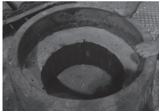
Рис. 4. Подготовка прибыльной надставки, футеровка матов
