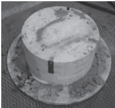
Рис. 3. Деревянный «болван» для монтажа по периметру экзотермических матов
