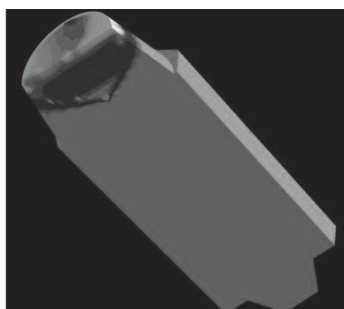
Рис. 1. Профиль усадочной раковины при использовании базовой прибыли и покровной смеси
