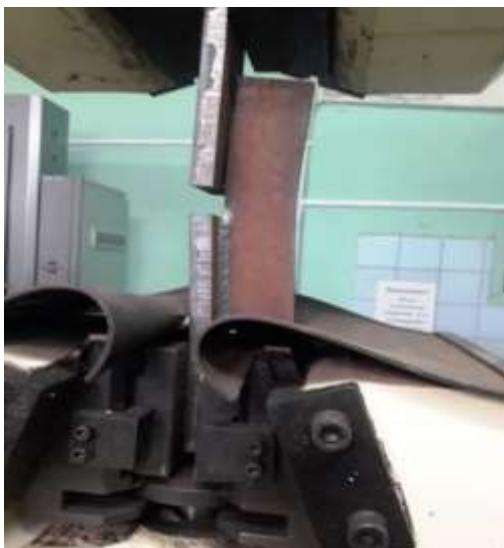
Рис. 6. Испытание образца в машине WAW-1000
