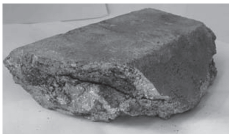
Рис. 1. Внешний вид слитка из гартцинка
