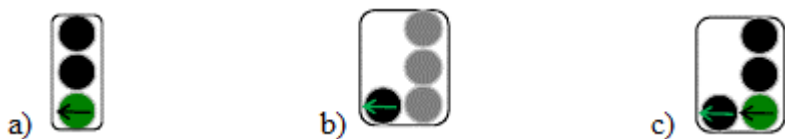
Рисунок 2 – Представление «зеленых» логических сигналов для движения налево: а) (обычного) зеленого; б) дополнительного зеленого; с) акцентированного зеленого
