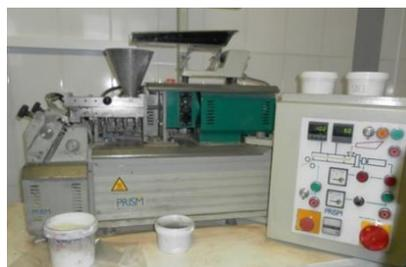
Рисунок 1 – Лабораторный экструдер для приготовления высокоогнеупорных порошковых покрытий
