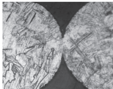
Рис. 3. Микроструктура пористого образца, полученного методом ЭИС. \times 100
