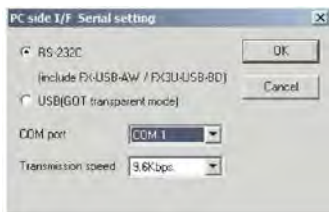
Рисунок 15.7 – Transfer Setup. Настройка подключения контроллера к программатору
