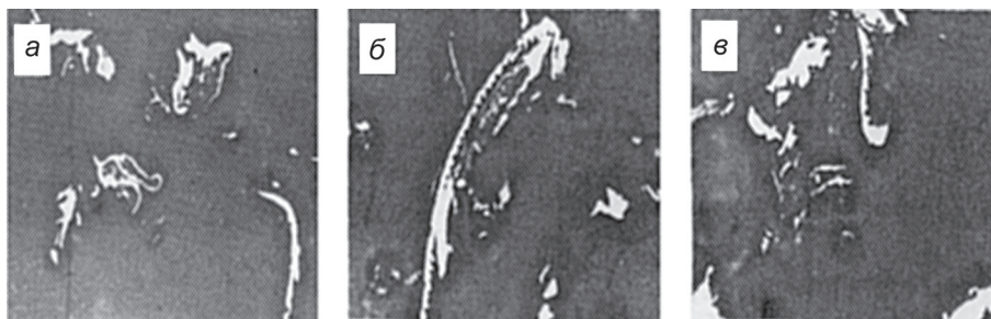
Рис. 1. Форма металлических частиц отходов шлифования стали Р6М5
