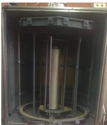
Рис. 1. Вакуумная камера с протяженным катодом
