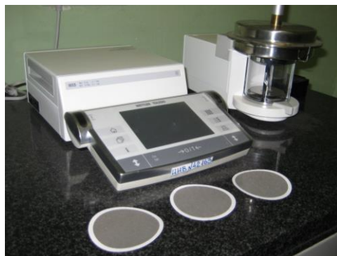
Рисунок 9 – Электронные весы Mettler Toledo MX5/A
