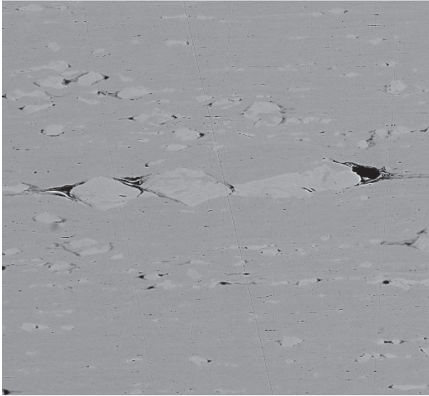
Рис. 1. Разрушение катанки при волочении в местах структурных «белых» пятен
