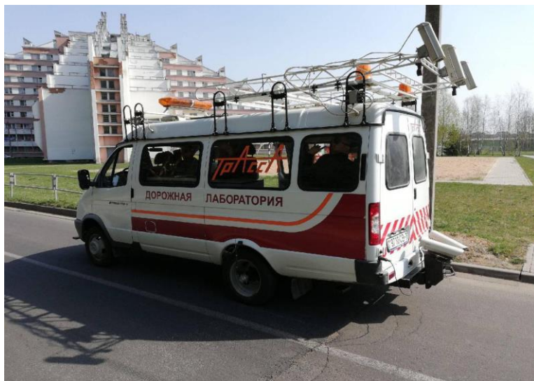
Рис. 1. Комплексная дорожная лаборатория КП 514СМП «Трасса»
