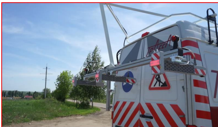
Рис. 4. Система фиксации дефектов дорожной одежды
