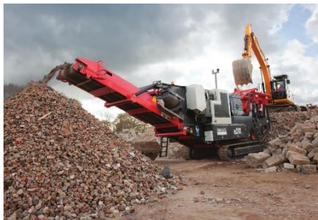
Рис. 6. Мобильный дробильный комплекс
