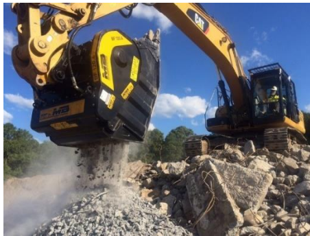
Рис. 5. Экскаватор с навесным оборудование (ковш дробилка)
