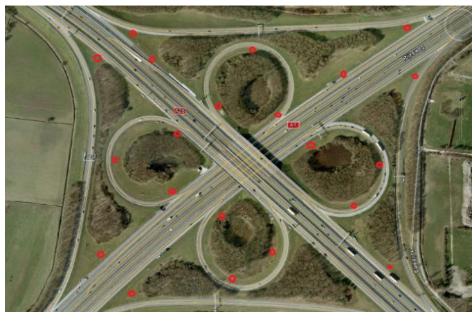
Рис. 1. Схема расположения датчиков отработанных газов от подвижных источников выброса (датчики отмечены точками)
