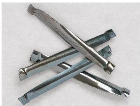
Рис. 2. Стальная фрезерованная фибра из шлаба
