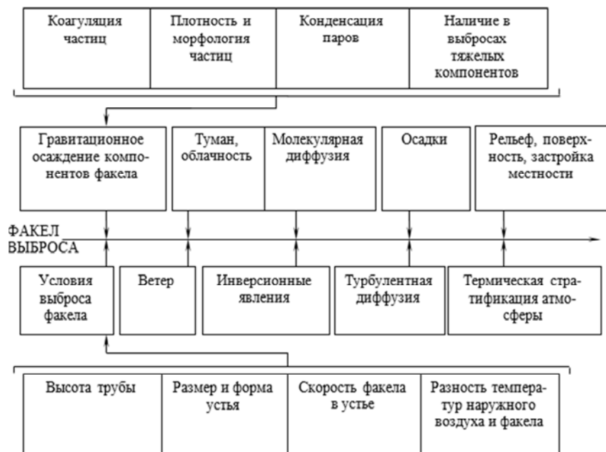
Рис. 6.1. Схема факторов, влияющих на рассеивание выбросов
