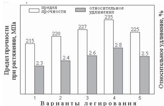
Рис. 7. Влияние вида и состава лигатуры Al + 5% Ti на механические свойства сплава АК5М2: 1 – без добавок; 2 – 0,1% Ti (кусковая лигатура); 3 – 0,1% Ti (гранулированная лигатура); 4 – 0,1% Ti (ленточная лигатура); 5 – 0,05% Ti (ленточная лигатура)
