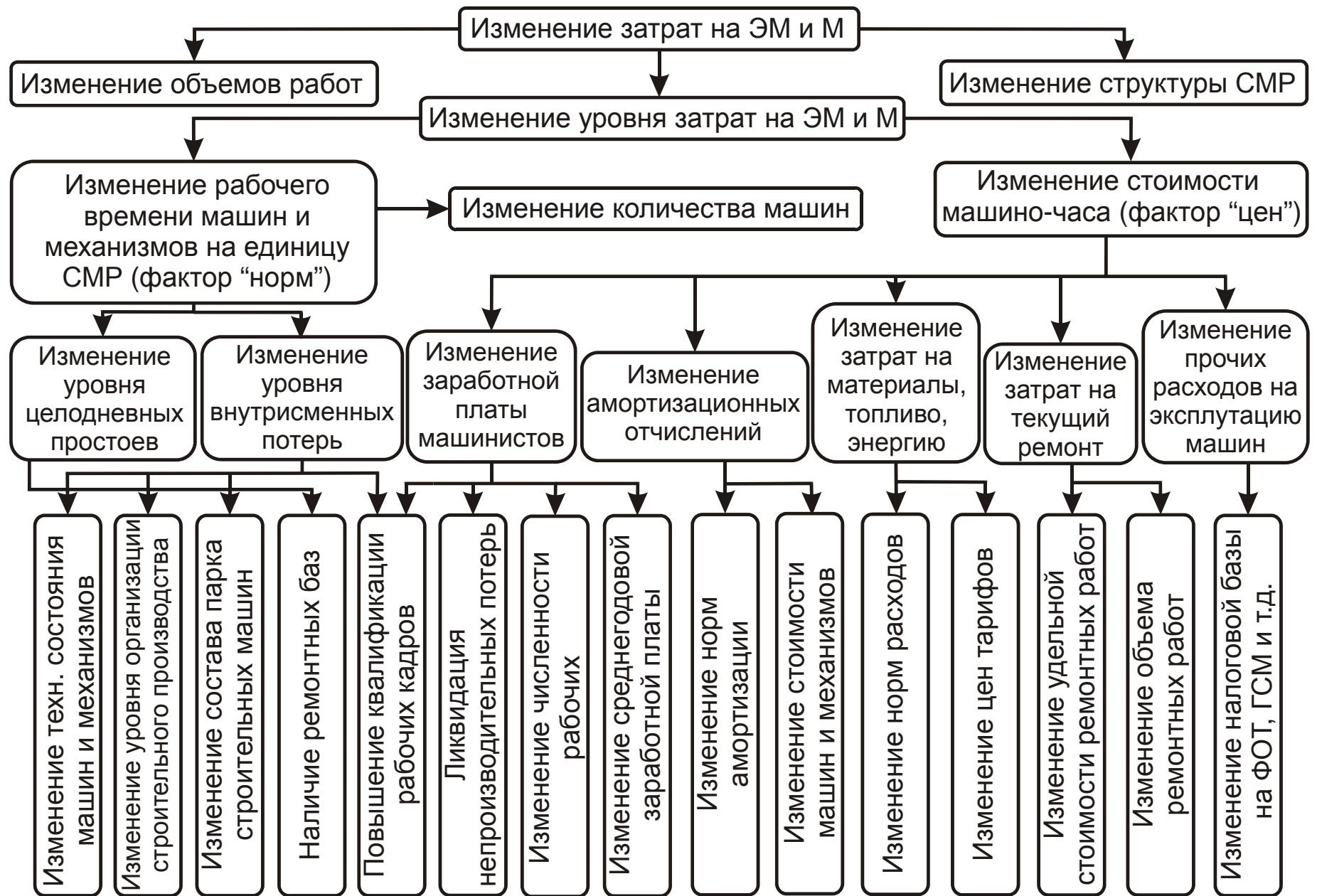
Рис. 1.10 Схема анализа затрат по статье «Эксплуатация машин и механизмов» (ЭМ и М)
