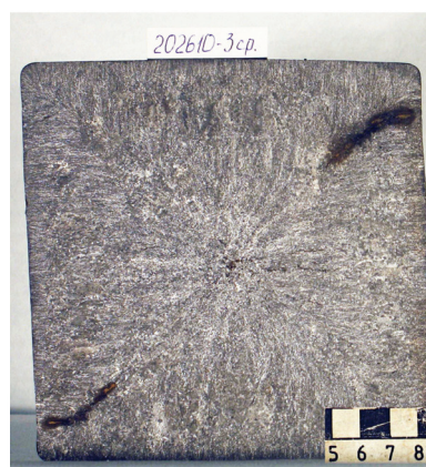
Рис. 3. Макроструктура темплета заготовки сечением 140×140 мм, отлитой в кристаллизаторе с гильзой итальянской фирмы (плавка № 202610-3)
