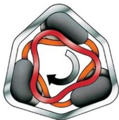
Рисунок 2 – Деформации жгутов при работе
