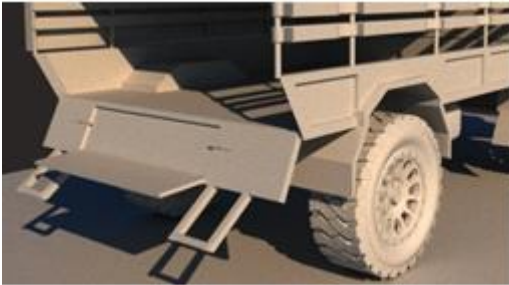
Рисунок 2 – Изменение заднего борта с рукоятями его открывания
